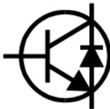
Para transistors NPN, o ânodo do diodo é ligado ao emissor do transistor. Para transistors PNP, o ânodo do diodo é ligado ao colector do transistor.
