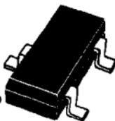
O *Atlas DCA* vai inteligentemente identificar tipos comuns de 3 redes terminais de diodos. Para aparelhos de 3 terminais, como redes de diodo SOT-23, as 3 sondas têm de estar ligadas, seja qual for a maneira. O instrumento identificará o tipo de rede de diodo e depois mostrará informação de cada dos diodos detectados em sequência. Os seguintes tipo de redes de diodo são geralmente identificados pelo *Atlas DCA*:
