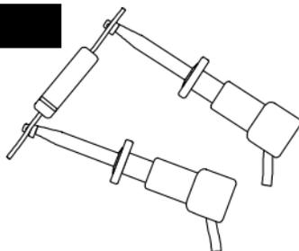
Pressionar o botão **scroll-off** mostrará a pinagem do diodo. Neste exemplo, o Ânodo do diodo está ligado à sonda vermelha e o Cátodo está ligado à sonda verde, consequentemente, a sonda azul encontra-se desligada. A quebra de tensão é então mostrada, dando indicação da tecnologia do diodo. Neste exemplo, o mais provável é que seja um diodo de silicó. Um Germanium ou Schottky pode render uma tensão de cerca 0.25V. A corrente a que o diodo é testado é também visualizada.
