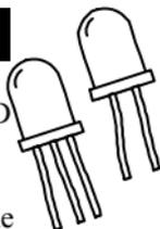
Um LED bicolor com 2 terminais consiste em 2 chips de LED que estão ligados em paralelo invertido dentro do corpo do LED. LEDs bicolores de 3 terminais são feitos ou com ânodos comuns ou cátodos comuns.
