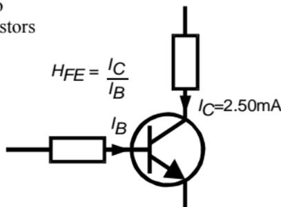
O ganho de todos os transistors pode variar consideravelmente com a corrente do colector, a tensão e também a temperatura. A valor de ganho visualizado não pode portanto representar o ganho experienciado noutras correntes e tensões do colector. Isto é particularmente verdadeiro para grandes dispositivos.
