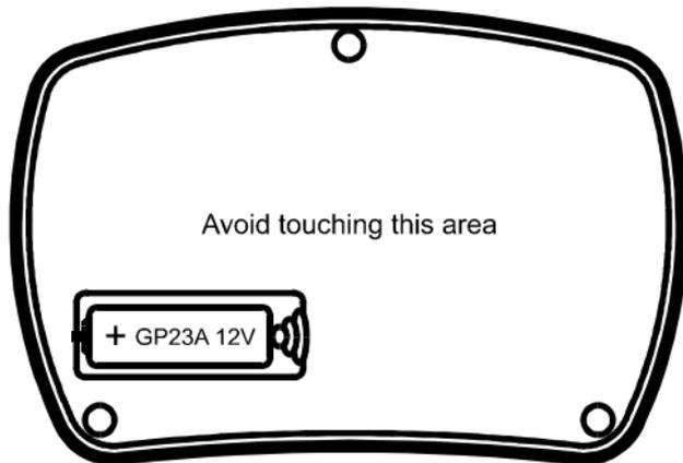
A bateria só deve ser substituída por uma de elevada qualidade idêntica ou equivalente ta uma Alcalina GP23A ou MN21 12V (10mm diâmetro x 28 mm comprimento).
