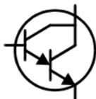
Se o dispositivo for um transistor Darlington (2 BJTs ligados juntos), a unidade irá mostrar uma mensagem semelhante a esta:
